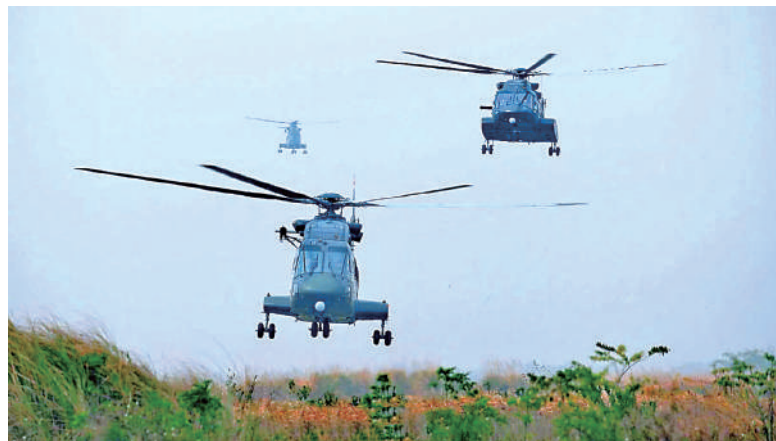
從直-8G(最前)與直-8L(右後)的合影畫面，可見直-8L機身明顯較寬。
