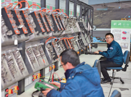
▲中國飛行試驗研究院科研人員進行C919飛機測試信號通道的驗證。新華社
