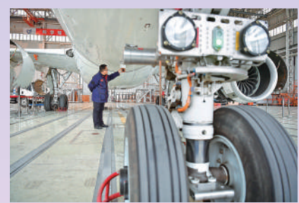
▲C919試飛團隊負責人在檢查用於觀察記錄前起落架的攝像頭。新華社
