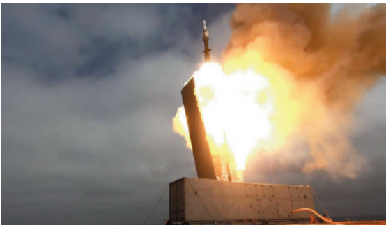
▲在「薩凡納」號飛行甲板上加裝的MK70垂直發射器發射標準-6。
