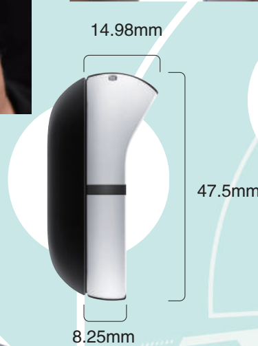
▲AI Pin可拆為兩部分：方形的裝置和電池組，兩邊能以磁吸的方式將裝置固定在衣服上。
