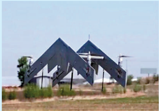
▲雙飛翼垂直起降固定翼無人機可以垂直起降。
