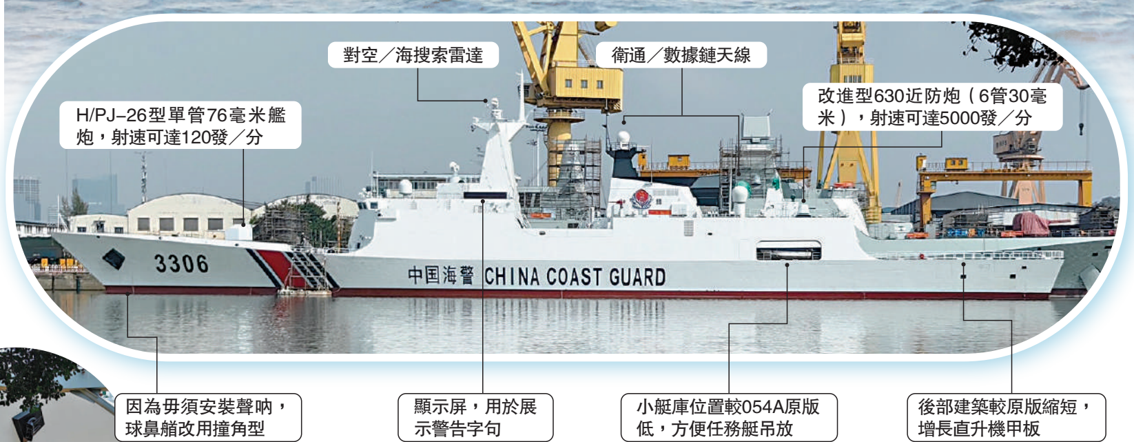
054A型海警船 噸位：4000噸級 計劃建造數量：10艘
