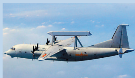
▲空警-200的「平衡木」式雷達已逐漸落伍。
