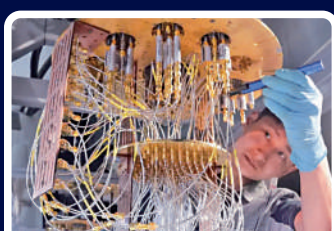
▲工作人員調試第一代超導量子計算機「本源悟源」。
