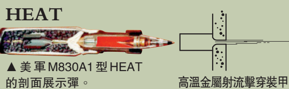
▲美軍M830A1型HEAT的剖面展示彈。高溫金屬射流擊穿裝甲
