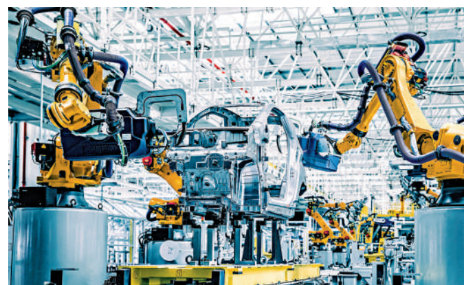
▲在廣州明珞裝備自動化焊裝生產線上，正在生產汽車白車身。
