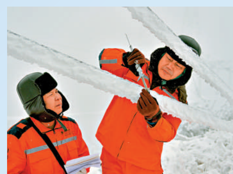
四川瀘定電力工人在二郎山頂觀冰站測量覆雪厚度。中新社
