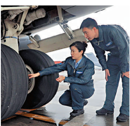
▲陳金蘭（左）在飛行前檢查運-20飛機起落架情況。
