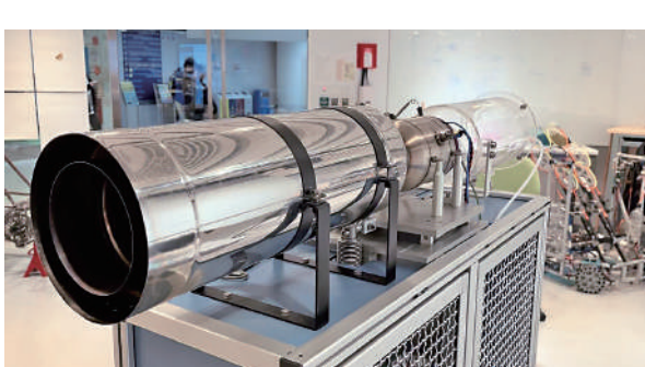
▲學員在課程中，需了解不少專業設備。圖為噴射引擎測試台。
