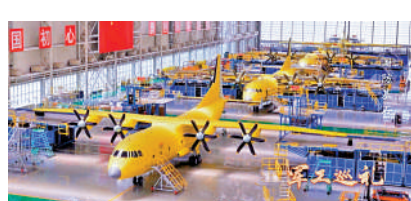
▲近年運-9已採用脈動式生產線，單一廠房可容納4機同時進行組裝。
