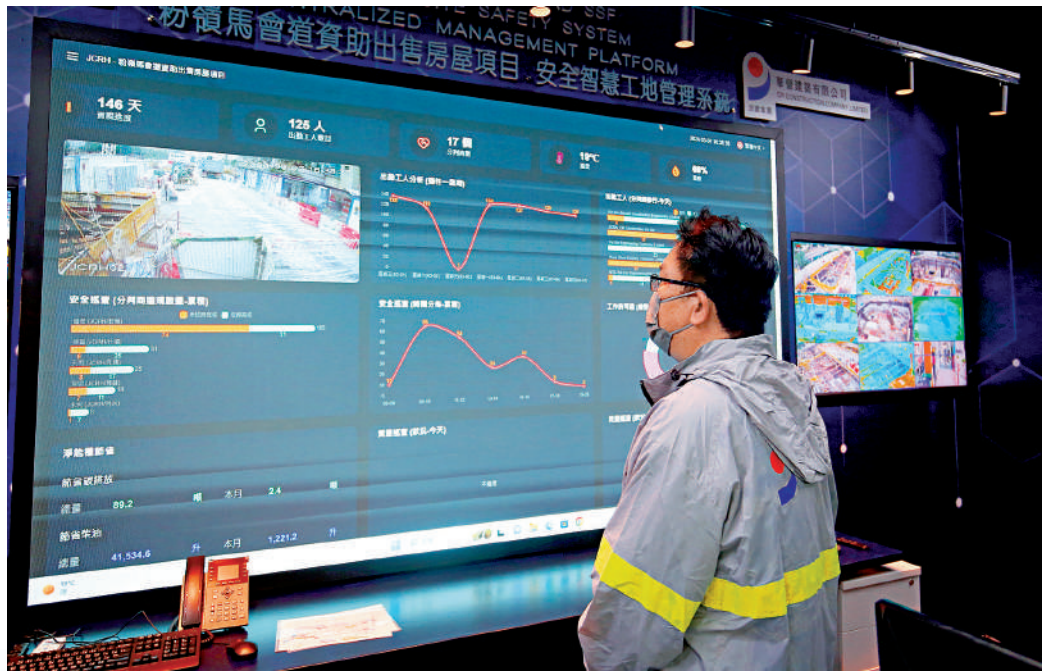
▲華營建築的安全智慧工地系統，包括中央管理平台，用AI相機對地盤進行安全監控（下圖）。大公報記者麥潤田攝
