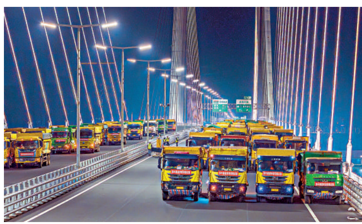
▲最大達136輛總重約5000噸的大貨車組將陸續上橋，對大橋進行「體檢」。
