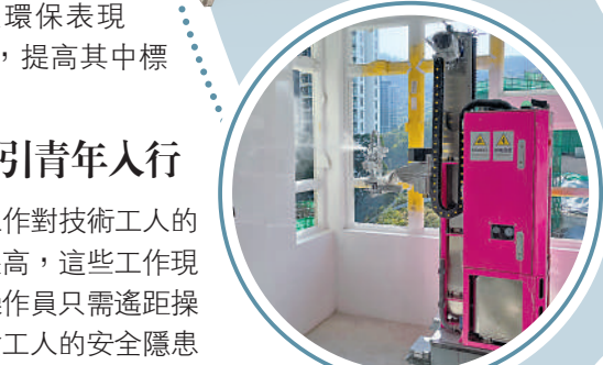
「室內油漆噴塗機器人」，機器人可為單位內牆自動進行噴塗工作。
