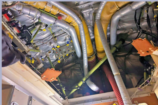
▲客機內部有面板脫落，露出管道等雜物。路透社
