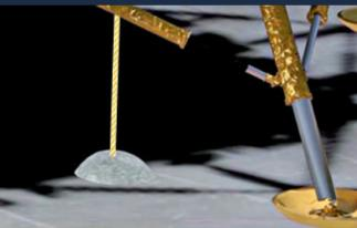
鑽取 鑽頭向下鑽進時，取芯袋跟隨着取芯管向下運動，鑽取到的月壤岩芯被頂進袋內，過程像「穿襪子」
