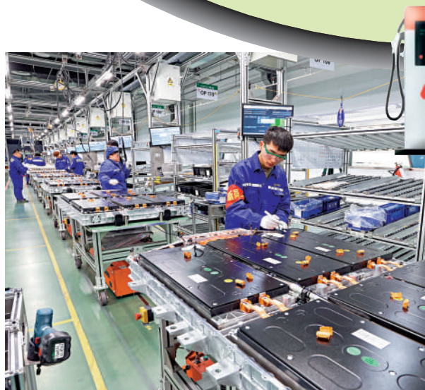
▲在上汽時代動力電池系統有限公司車間，工人安裝新能源汽車動力電池系統。 新華社
