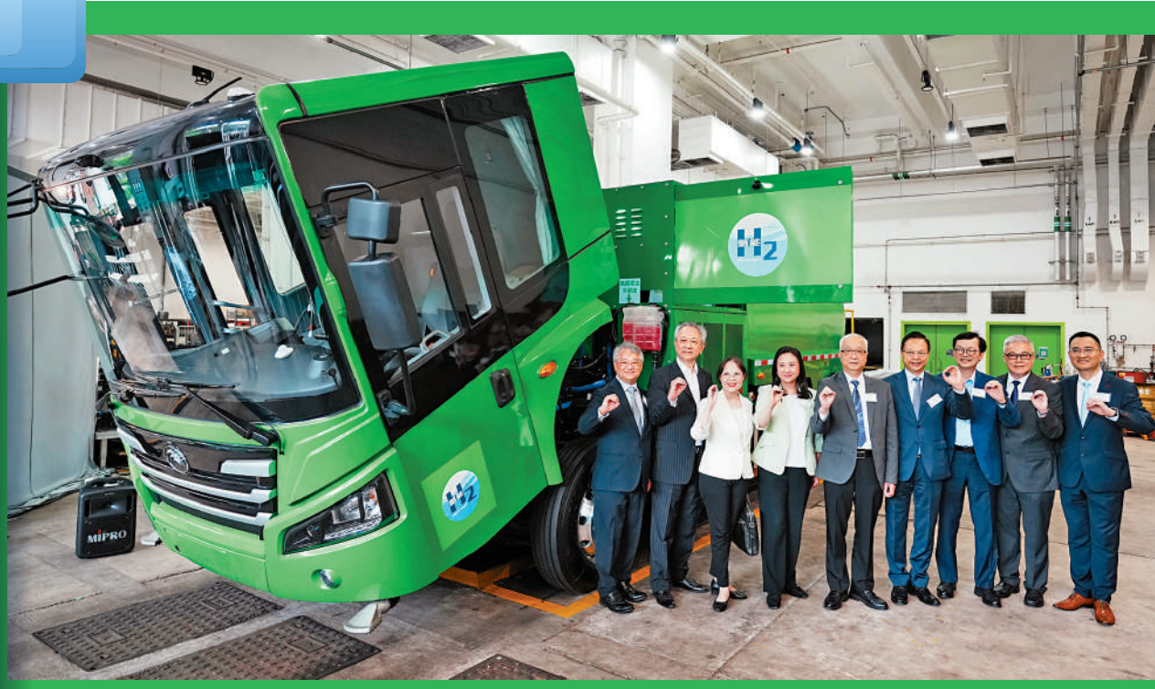
食環署下半年將啟動三輛氫能洗街車試驗計劃。該車每次輸入20公斤燃料可供車輛行駛三百至四百公里。
