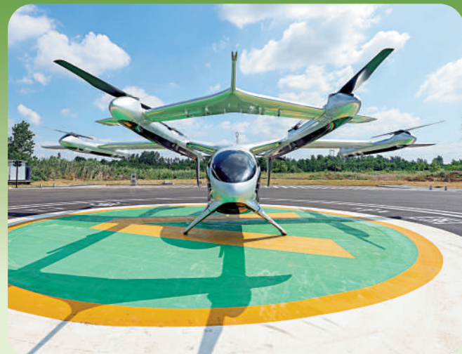
▲▼南京市一間公司日前測試eVTOL無人機，垂直起飛後在空中轉換為固定翼飛行模式，水平巡航並飛越長江。
