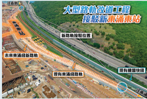
東涌綫延綫大型路軌改道工程位置。
