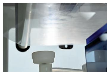
▲機器以高壓方式將聚合物溶液製成納米纖維噴向收集裝置，製作靜電紡絲。 中新社
