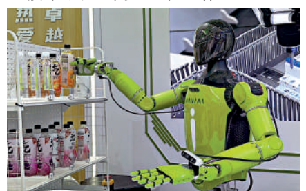
▲人形機器人能根據語音指令，精準拿取對應飲料。大公報記者連懋鈺攝
