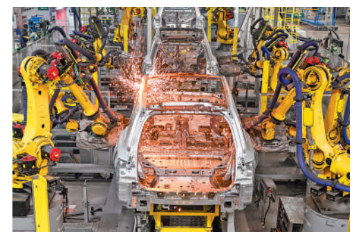
▲在理想汽車江蘇常州基地車間，機械手臂進行焊接作業。 新華社
