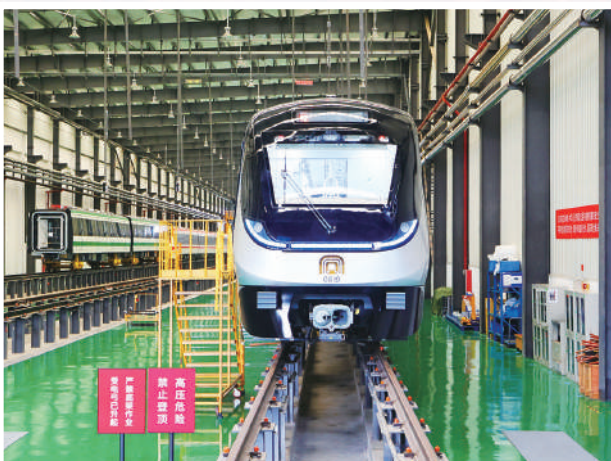
●合肥中車軌道交通車輛有限公司車間，一列無人駕駛軌道交通列車總裝完畢。
