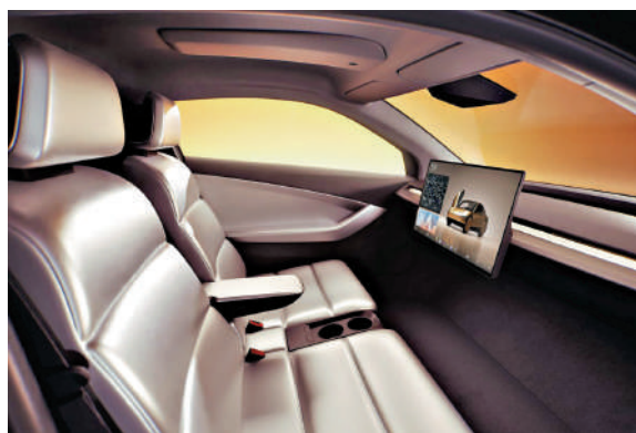
▲CyberCab車內沒有方向盤、油門和制動踏板。
