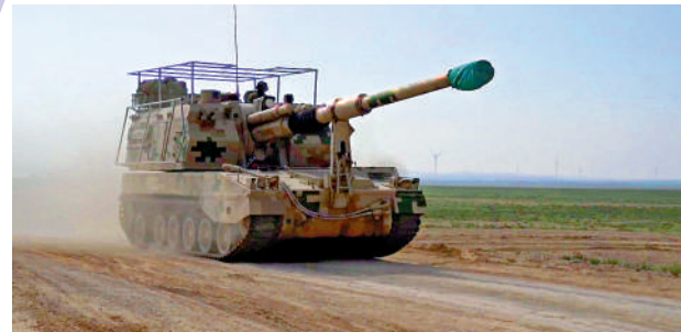
▲西部戰區第76集團軍PLZ-05式自行加榴炮已加裝鋼製格柵網。
