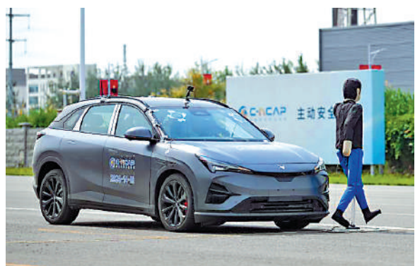
▲如果駕駛過程中突然有行人從旁邊出現，智能網聯汽車對「鬼探頭」能啟動緊急制動。圖為生產商用假人進行主動安全自動緊急制動測試。
