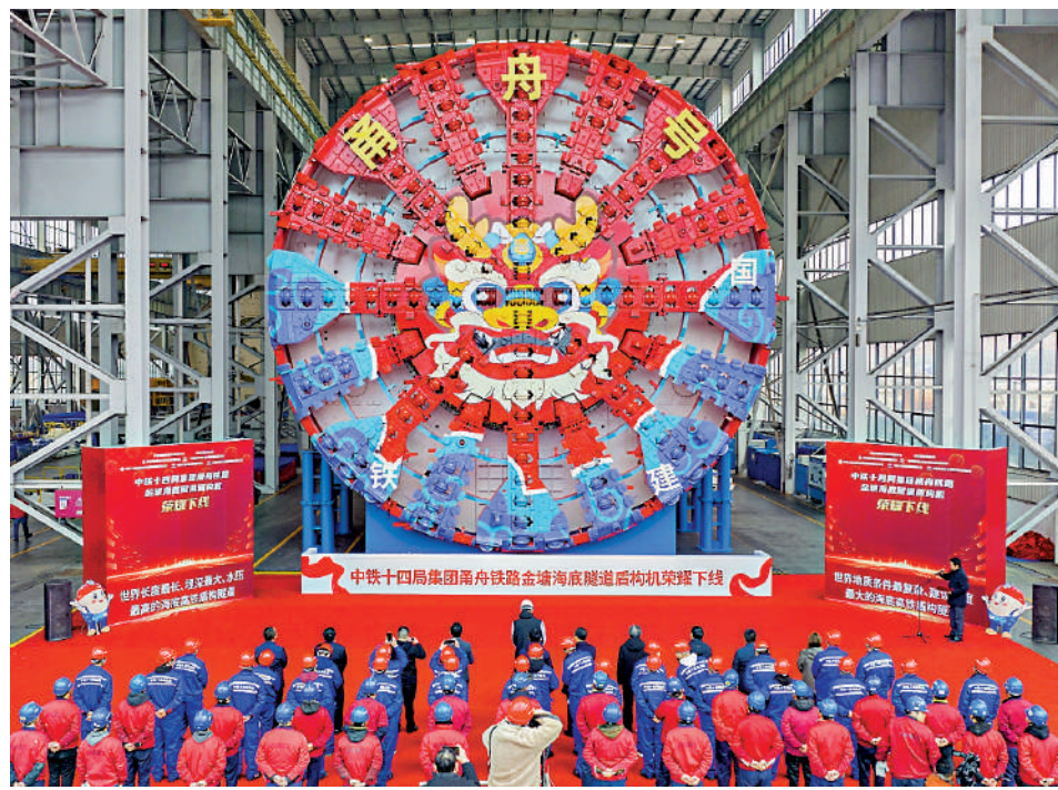
▲金塘海底隧道計劃使用「甬舟號」盾構機從寧波側掘進4940米，預計明年5月進入海域段施工。 新華社
