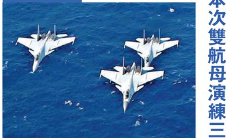
殲-15改進型艦載機首次公開展示。它配備新一代電子設備，且既能彈射起飛，也能滑躍起飛。圖中機頭淺色者為殲-15改進型，機頭深色者為前一型殲-15。
