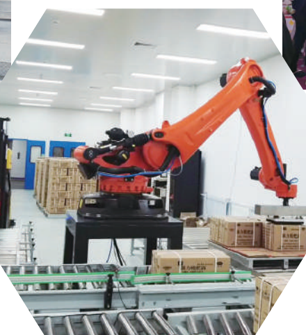
▲康隆藥業自動化機械手臂應用，實現了從制劑生產到運輸至立體貨架上，整個流程的智能化、自動化、無人化。
