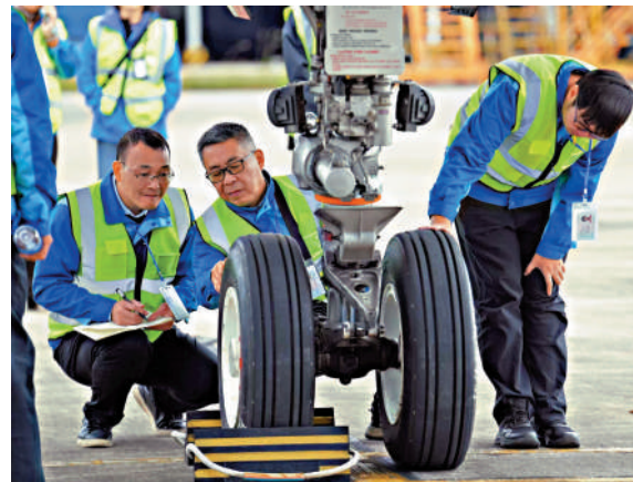
國內首條航空輪胎數字化工廠，智能化達到世界一流水平。生產線按照工業4.0標準設計建造，建立了完善的數字化與信息化系統。技術人員查看試飛後輪胎狀態。
