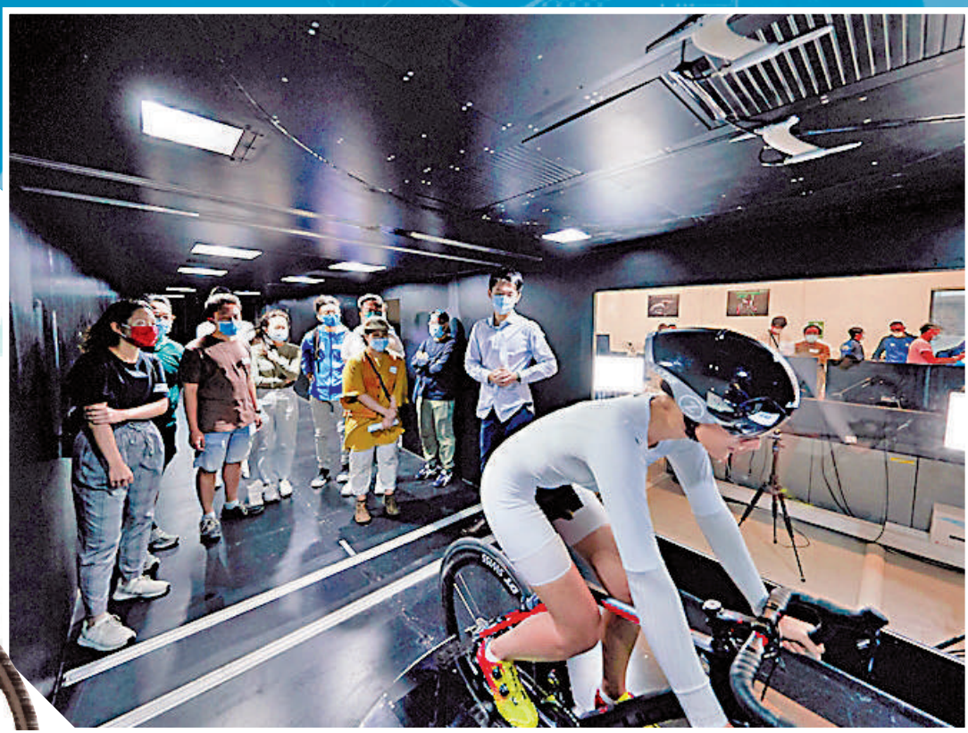
▲體院與科大於2019年合作開展運動空氣動力學研究計劃，透過科大的風洞實驗室設施，為香港單車隊進行單車測試、阻力測試及單車服研製等，以助提升港隊表現。
