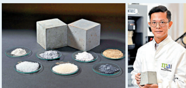
▲香港都會大學科研團隊研究利用塑膠廢料製造環保磚，李志豪博士指使用環保磚可以降低約5%建築成本。
