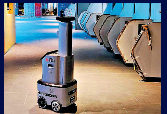
T&C工地測試及作業機械人 功能 驗樓、測量現場的空氣質量、噪音和光照等數據分析
