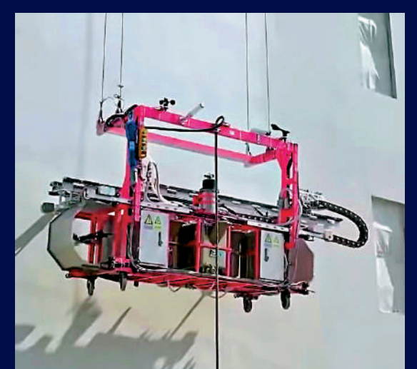
外牆噴塗機械人 功能 外牆油漆
