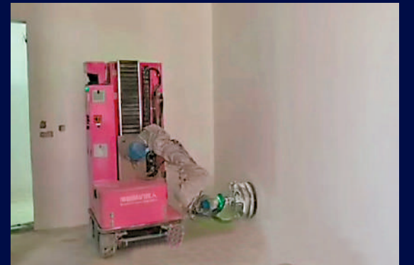
牆身缺陷修補機械人 功能 打磨及修補牆身
