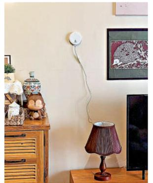
▲毫米波雷達僅通過雷達發出與接收毫米波，判定人體所處的位置與基本形態。
