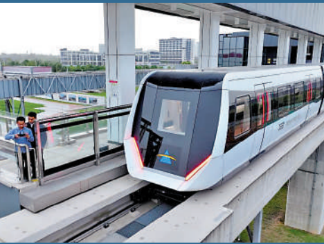
一列三編組內嵌式中低速磁浮列車停於位於四川成都的磁浮示範線上。新華社
