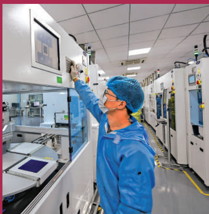
▲在杭州正銀電子材料有限公司的實驗室內，自動化設備在進行光伏板的絲網印刷。新華社
