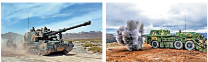
▲PLZ-05型155毫米履帶式自行加榴炮。 ▲PCL-181型155毫米輪式車載加榴炮。
