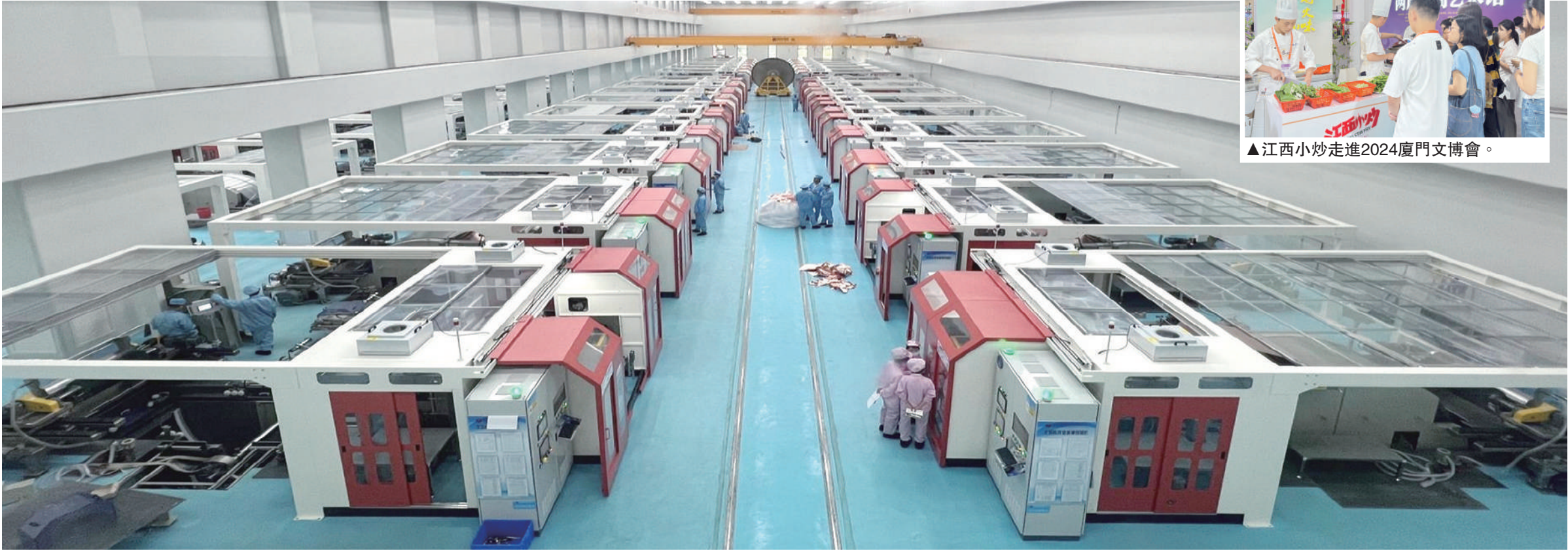
▶江西諾德銅箔有限公司超薄鋰電銅箔項目生產線，年產能2萬噸。
