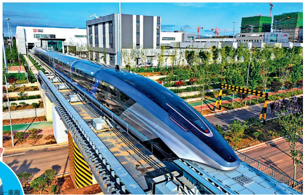
◀ 中國於磁浮列車領域不斷創新。圖為2021年7月，由中國中車承擔研製、具有完全自主知識產權的時速600公里高速磁浮交通系統在青島成功下線，是世界首套設計時速達600公里的高速磁浮交通系統。
