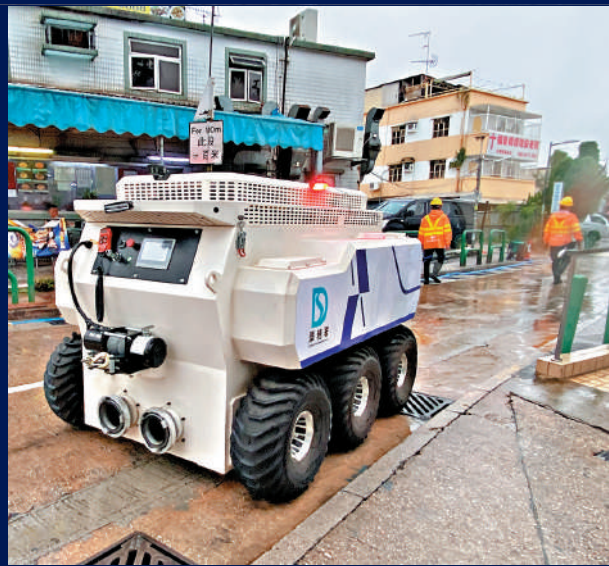
▲渠務署在新田出動排水機器人「小禹一號」協助清理水浸。 大公報記者葉浩源攝
