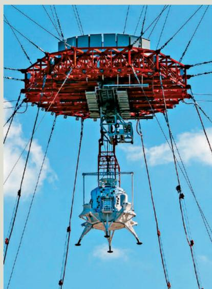
▲8月7日，中國攬月月面著陸器起飛綜合試驗在河北試驗場圓滿完成，標誌著中國載人月球探測工程研製工作取得新的重大突破。新華社
