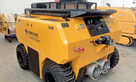
將智能系統集成在機器人內部，無需外接動力源，可快速部署到位。
