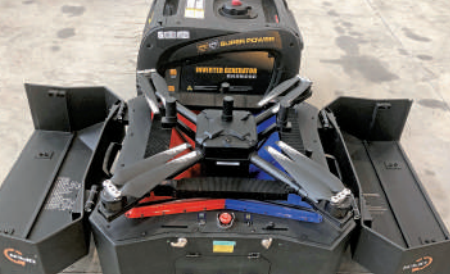
裝載照明燈具，能飛至50米的空中為一個標準足球場大的面積提供照明。
