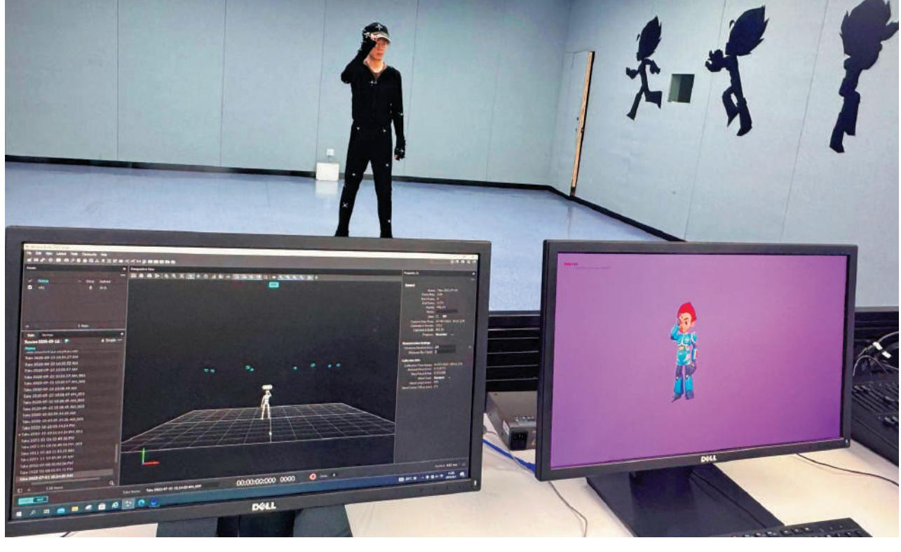
▲在「之江一號」數字攝影棚中，一名動捕演員正揮舞手臂、旋轉躍躍，150個高精度相機實時捕捉動作，將表情和肢體動作轉化成虛擬角
