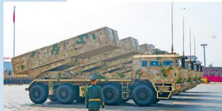
遠程火炮方隊 ▲遠程火炮方隊的兩型191遠程箱式火箭炮，具有射程遠、精度高、反應速度快、火力體系廣、點面結合等特點，箱式彈藥補充方式能大幅縮短作戰準備時間。圖為遠程火炮方隊接受檢閱。 新華社
