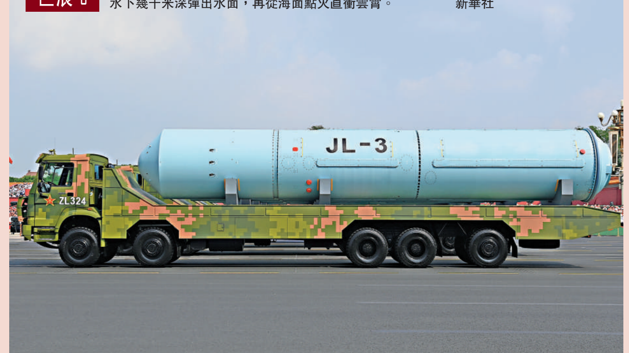
巨浪-3 核導彈第一方隊的巨浪-3是裝在戰略核潛艇裏的潛射戰略導彈，從水下幾十米深彈出水面，再從海面點火直衝雲霄。 新華社
