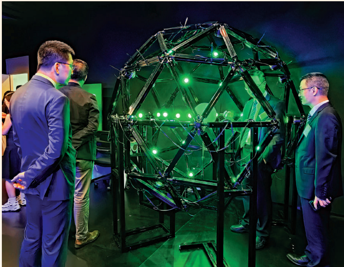
▲在深圳前海的智能傳感與影像實驗室內，球狀儀器中不同方向的燈光依次閃爍不同顏色，模擬人臉拍攝的效果，這項技術可實現對人臉皮膚微結構的快速重建。 大公報記者李望賢攝
